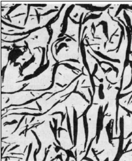
Microfotografía de hierro de fundición gris (100x) que muestra el carbono en forma de láminas de grafito.
